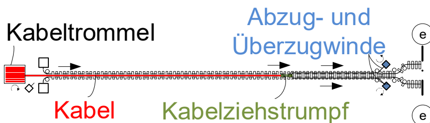
Abb. 1.3 Schritt 2: Längsverzug und Ablage des Kabels auf dem Rollgerüst am Transportzielort ©
